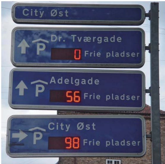
图85 亚琛可停车时间标识。有效改善车辆寻找停车处引起的交通拥堵 （图片来源：Andrea Broaddus，丹麦哥本哈根，2007）
