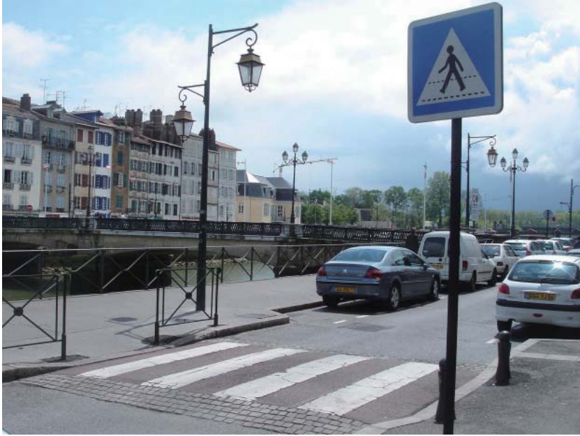
图33 巴庸一条车道的瓶颈收缩、信号、减速带使得车辆减速 (图片来源: Andrea Broaddus, 法国巴庸, 2007)
