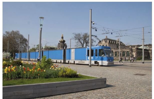
Figure 57 : Un trajet en tramway cargo à Dresde remplace 3 trajets en camion qui traversent le centre-ville, Dresde.
