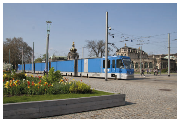
Figure 57 : Un trajet en tramway cargo à Dresde remplace 3 trajets en camion qui traversent le centre-ville, Dresde. Source : DVB AG, 2011.
