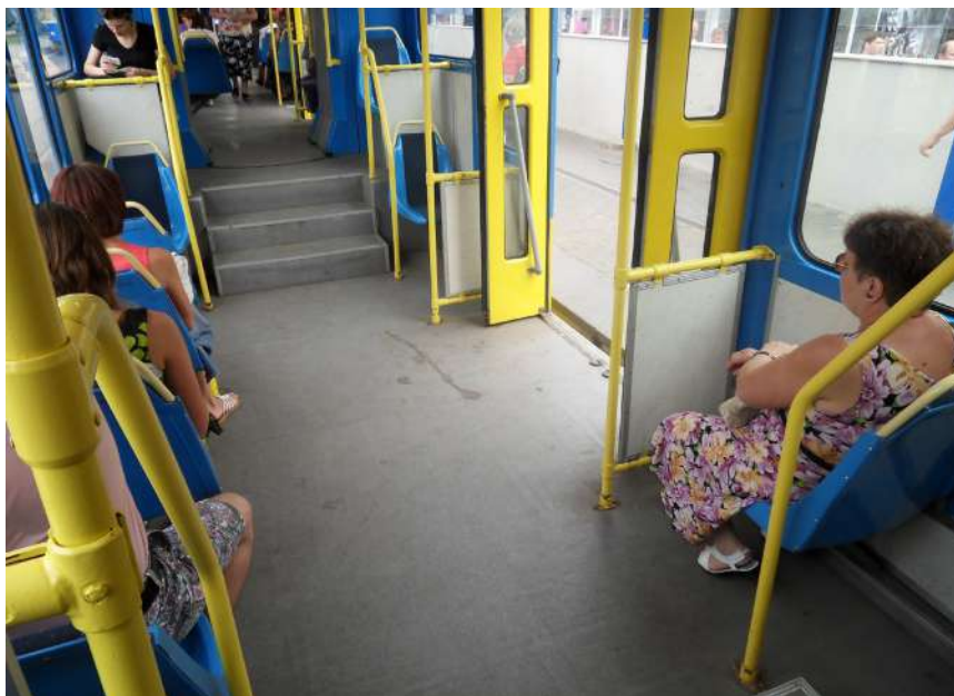
图53：更新有轨电车通常比采购新车更经济。该图显示了一辆经过更新的与登车口齐平的电车，在基辅电车系统中运行。 ©Mathias Merforth 2012
