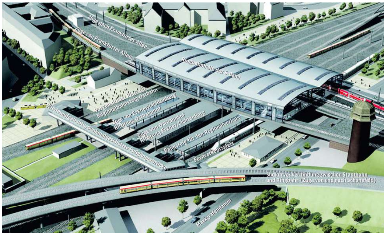
Мал. 40. Багаторівнева станція пересадки між метро та приміською електричкою (Осткройц, Берлін)
