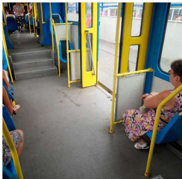
Мал. 53. Модернізація трамваю часто є економічно вигідною альтернативою придбання нового рухомого складу. На фото – модернізований трамвай з низькою підлогою, який використовується Київською трамвайною системою.
