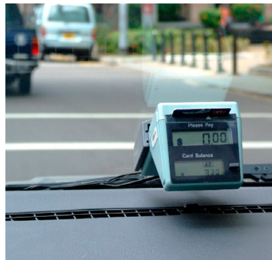
Figuras 22a, b Lector de Tarificación Electrónica de Vías (izquierda) y sistema de recaudación de cuotas de pasaje a bordo (derecha) en Singapur.
