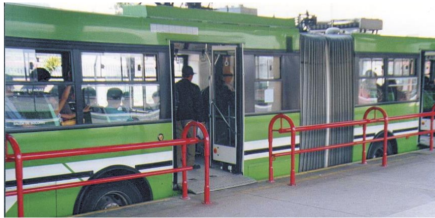
Fig. 25 Rampas retráctiles en Quito, Ecuador Lloyd Wright
