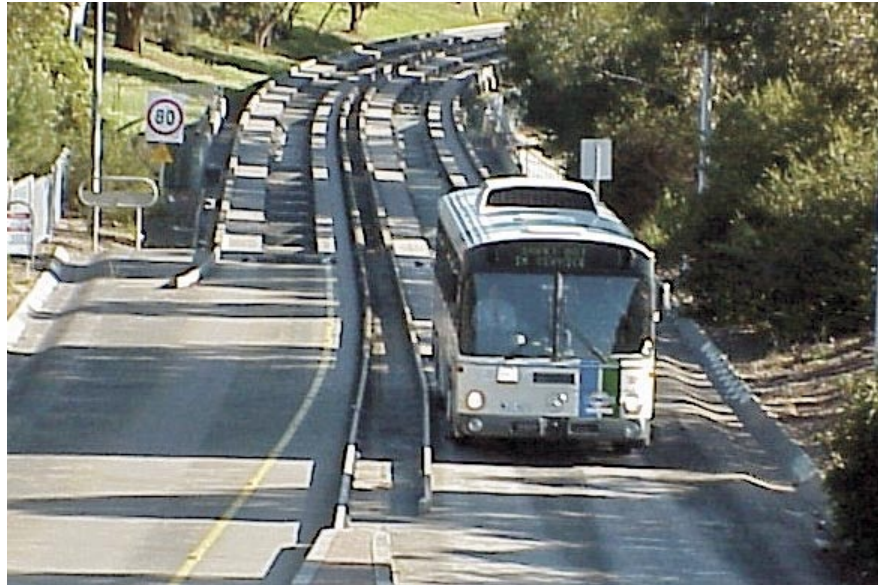
Fig. 38 El O-bahn de Adelaida usa guiado mecánico Cortesía de la Administración Federal de Transporte Público
