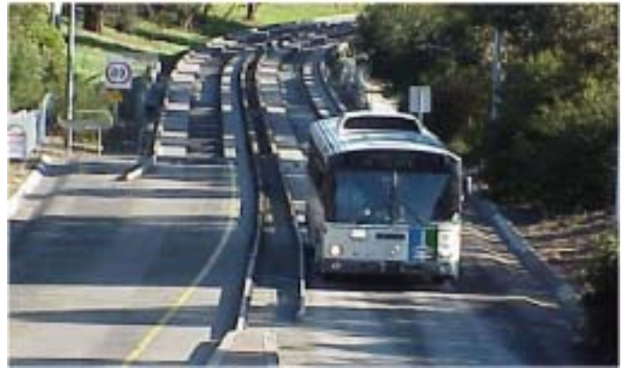
△<그림 36> 기계적 가이드를 사용하는 Adelaide의 O-bahn
