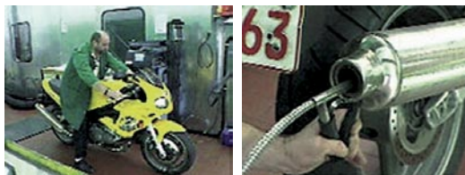
图 20: 对摩托车进行因催化而达到的废气控制是达到严格尾气标准的最便宜的方法。 (SWR)
