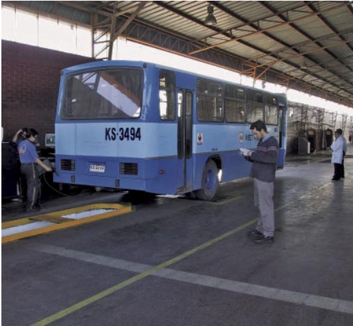
图 13： 在底盘测力计显示满载的情况下进行的公共汽车的定期废气控制。 (Frank Dursbeck)
