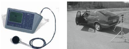
图 23: 声级检测设备
