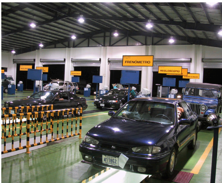
Fig. 28 Station de test avec six voies d'inspection    Heredia.
