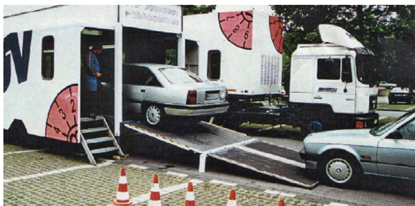
Fig. 10 Une installation mobile de contrôle en Allemagne.
