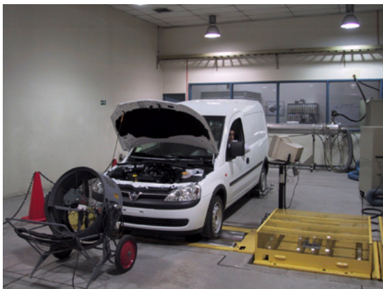
Fig. 21 Le laboratoire des émissions d'échappement, centre de contrôle et de certification des véhicules. Cette installation effectue les essais d'homologation pour les véhicules neufs.
