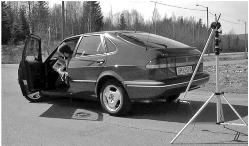
Fig. 33 Installation de mesure du niveau sonore.
