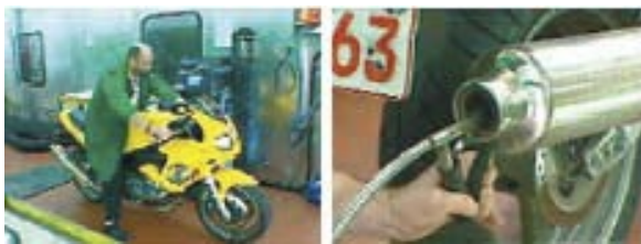
Hình 20 Kiểm tra khí thải xe máy là cách có hiệu quả nhất để đáp ứng các tiêu chuẩn khí thải nghiêm ngặt SWR
