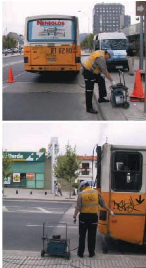
Hình 14 Kiểm tra khí thải định kỳ các xe buýt tại thời điểm chất đầy tải trên lực kế khung gầm Frank Dursbeck
