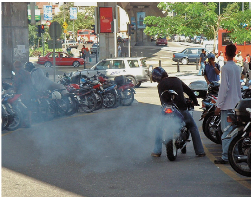
Fig. 14 Prácticas inapropiadas de lubricación llevan a altas emisiones de humo blanco de las motocicletas de dos tiempos.
