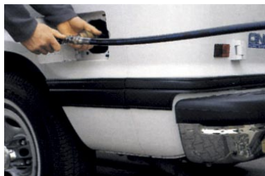
图15: 装有塞子 的高压管 (Ruhrgas AG)
