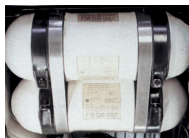
图16: 安装在后部 的燃料罐 (Ruhrgas AG)
