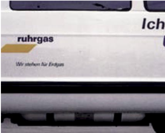
图 17： 侧视：车下的高压油罐 (Ruhrgas AG)
