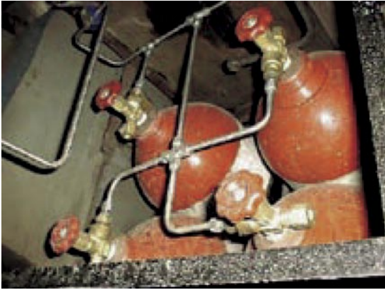
图 23： 改造公交车中设有压力释放环的 CNG 管道 (科学与环境中心，Erlandsson 和 Weaver，2002)
