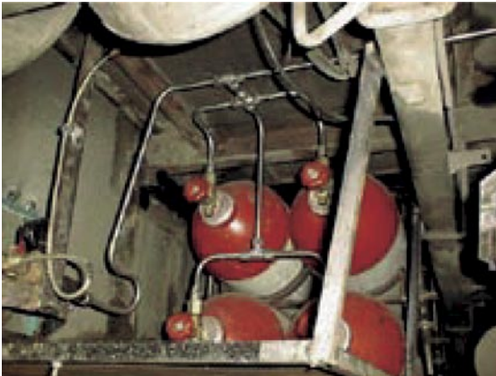
图 24： 改造公交车中设有压力释放环和气压不足报警装置 的 CNG 管道 (科学与环境中心，Erlandsson 和 Weaver，2002)
