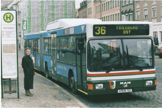
Fig. 1-1 Bus a gas natural MAN en operaciones en Augsburg, en Alemania.
