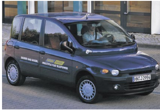
Fig. 1-12 Multipla Fiat Blupower, 1.6 l, 4 cilindros, motor de 4 válvulas.
