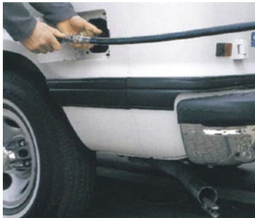
Fig. 2-3 Manguera de alta presión con acoplamiento de bujía. Ruhrgas AG
