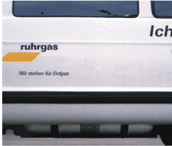
Fig. 2-5 Vista desde el costado: Tanques de alta presión bajo el vehículo. Ruhrgas AG
