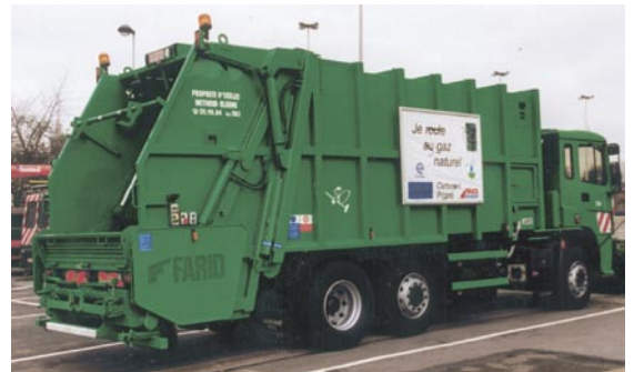
Fig. 1-6 Camión de basura ERF tipo EC 12,30 TMU 6x2, 26 toneladas métricas, en operaciones en Ixelles, motor a gas natural dedicado Perkins, tipo: Eagle 340 TxSi.
