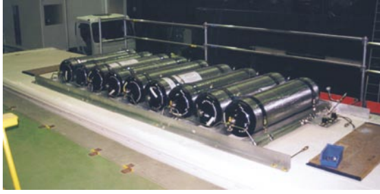
Fig. 1-4 Ubicación de tanques sobre el techo de un autobús.
