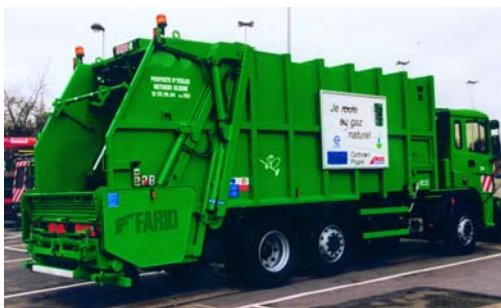
Gambar 1-6 Truk sampah ERF tipe EC 12.30 TMU, 6x2, 26 ton kubik, saat beroperasi di Ixelles, dengan mesin bahan bakar gas Perkins tipe Eagle 340TxSi
