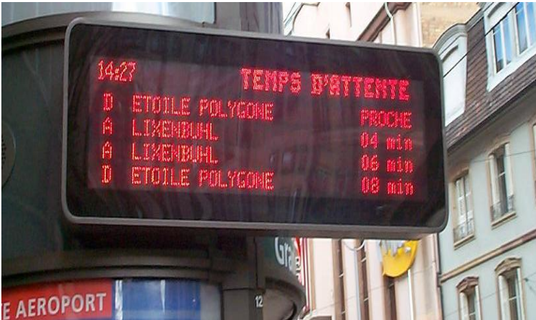
图 9 斯特拉斯堡的实时 公共交通信息提示 板 Klaus Banse 2003, GTZ Urban Transport Photo CD
