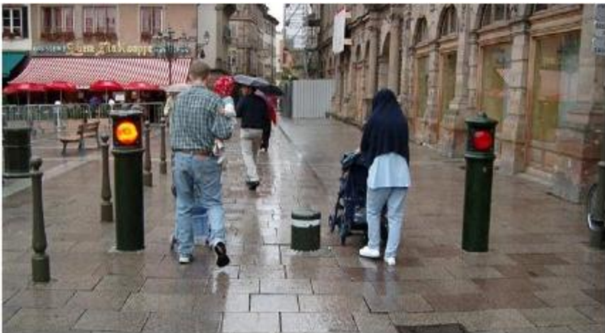
Hình 5: Rào chắn ô tô tại lối vào khu vực cấm ô tô tại Strasbourg (Nguồn: GTZ 2003)
