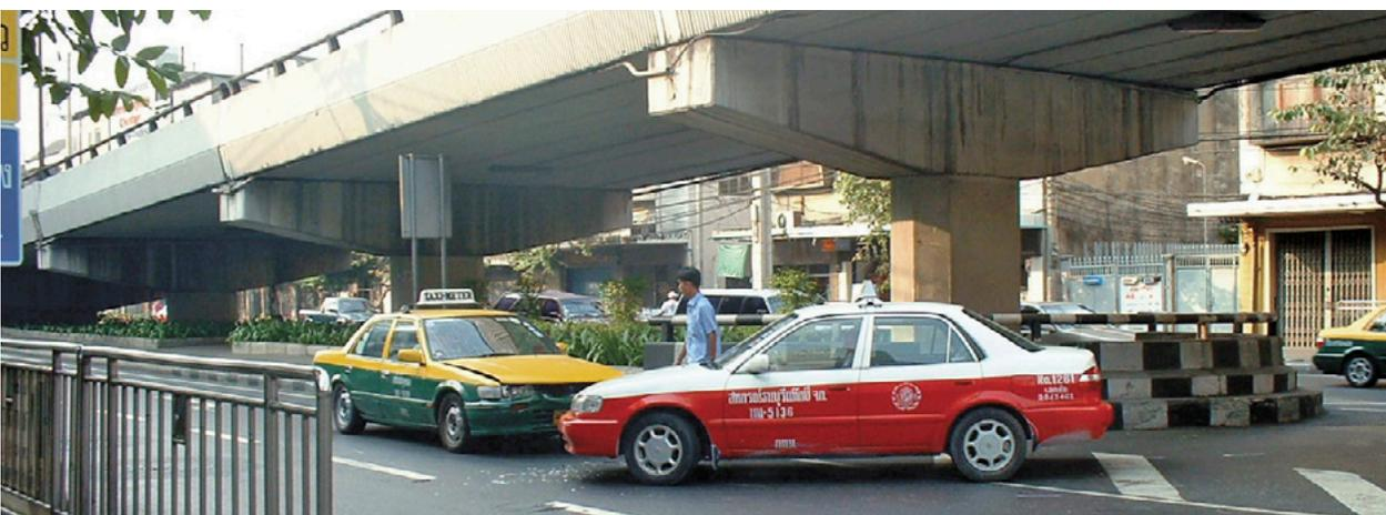
Figura 9: Una combinación de medidas de bajo costo como mejor encauzamiento, separadores viales y señales de tránsito, por ejemplo – podrían haber evitado este siniestro en Bangkok, Tailandia, que fue causado por la confusión que provoca una pista de autobús con dirección contraria a la de la vía. © Karl Fjellstrom, December 2001
