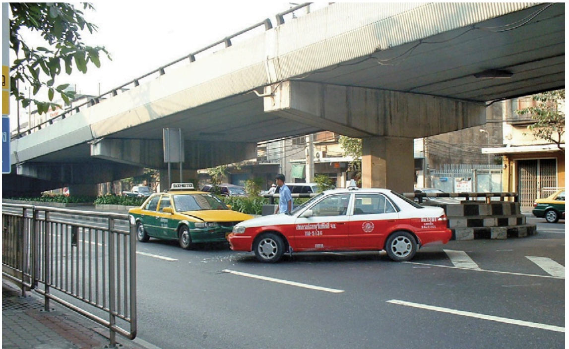
Fig. 8 Des mesures peu coûteuses telles que l'amélioration de la canalisation des flux par un marquage et des panneaux de signalisation par exemple auraient pu éviter cet accident à Bangkok, Thaïlande, qui a été causé par la confusion créée par une voie de bus à contresens.
