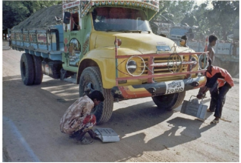
Ảnh 19: Nhằm mục đích kiểm soát việc chở quá tải, cảnh sát giao thông tại tỉnh Tangail, Bangladesh sử dụng thiết bị đo lường di động Hình ảnh cung cấp bởi Rainer Kuhnio
