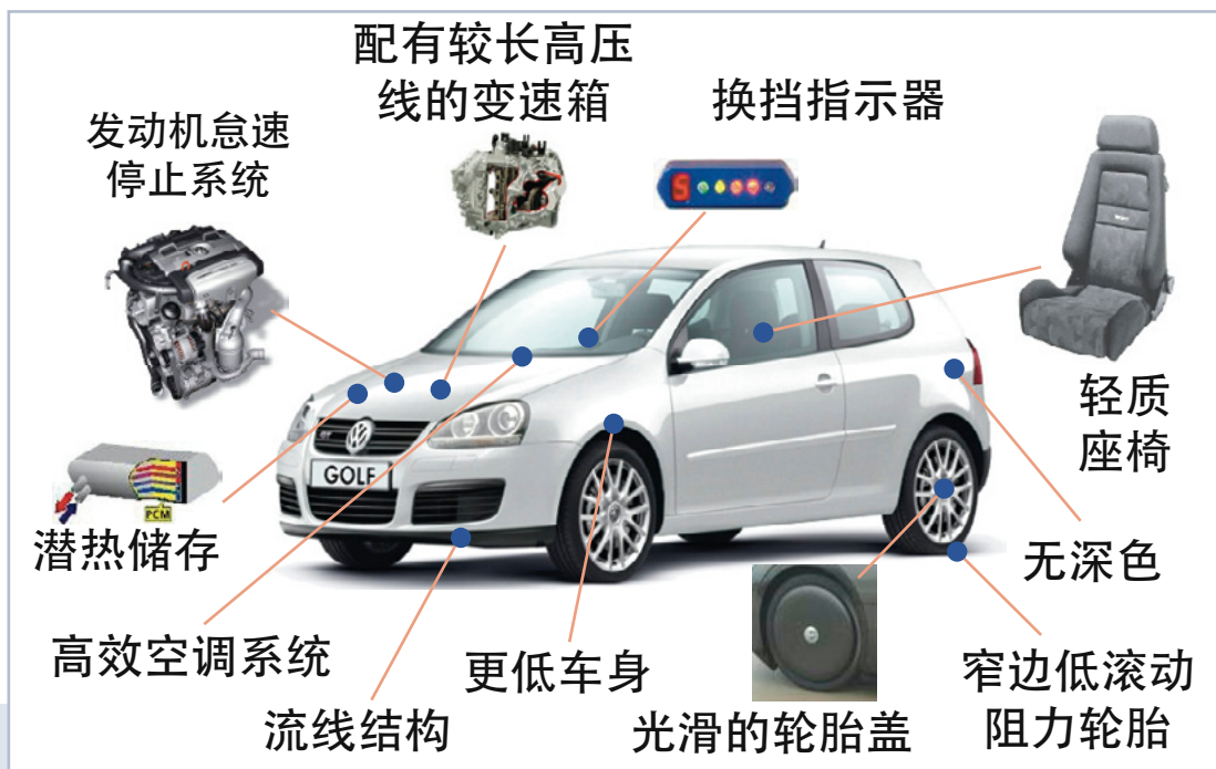
图14：提高轻型汽车能效的技术方案
