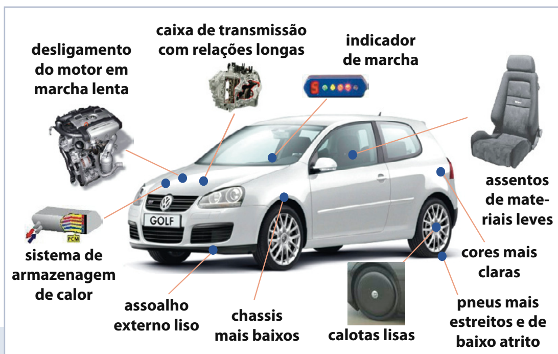
Figura 14: Opções técnicas para aumentar a eficiência energética de veículos leves. Fonte: Axel Friedrich via GIZ
