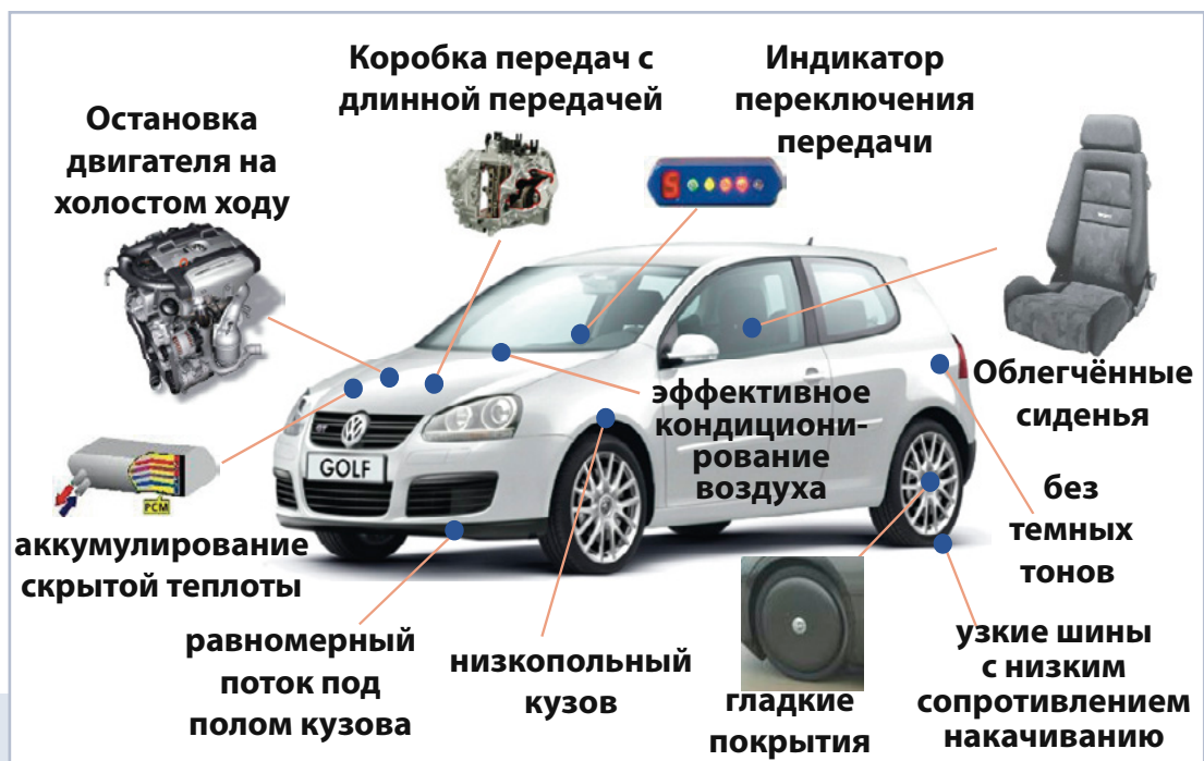
Рисунок 14: Варианты технических решений по повышению эффективности использования энергии малотоннажными автомобилями. Источник: Аксель Фридрих через GIZ
