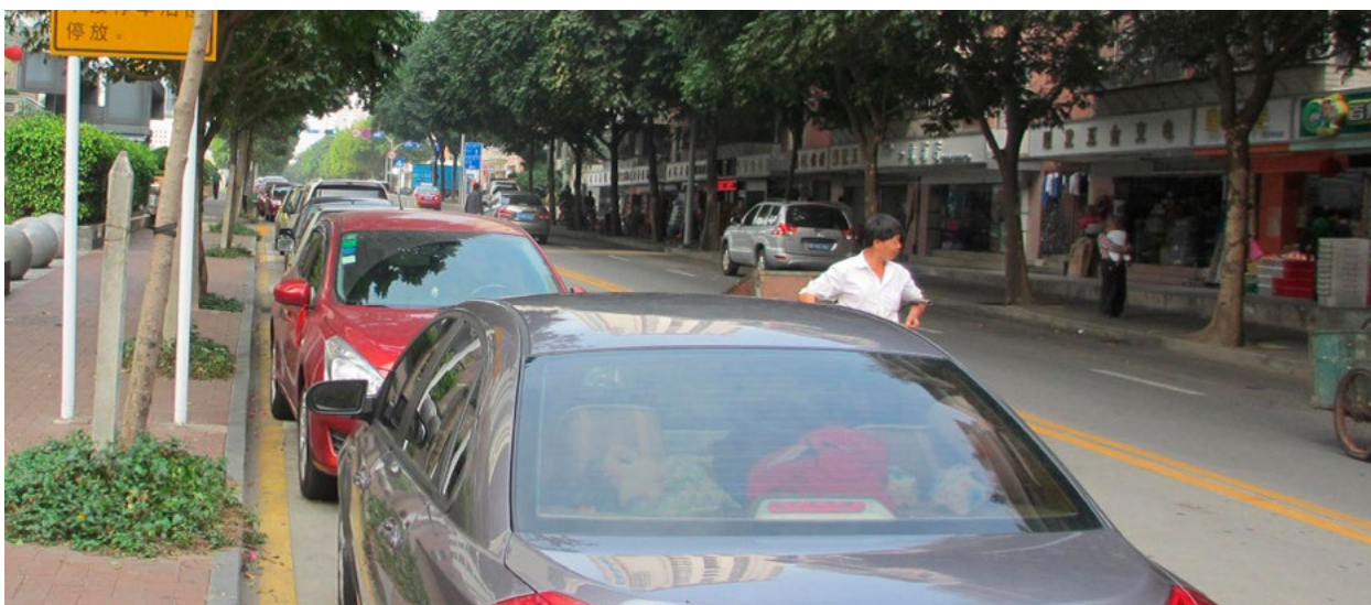
Fig. 51: La eliminación del estacionamiento en mitad de cuadra en esta calle de Shenzhen, China, probablemente no aumentará la capacidad del tránsito porque las intersecciones son, con casi toda seguridad, el factor limitante. © Paul Barter
