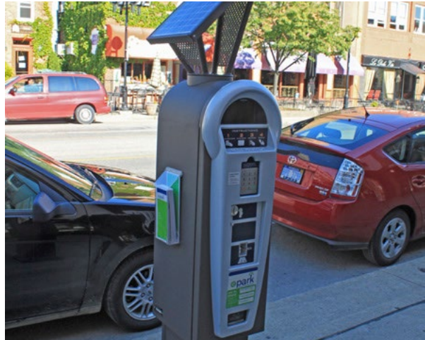
Fig. 68: Parquímetro inteligente (digital) para espacios múltiples en Ann Arbor. © Dwight Burdette via Wikimedia Commons
