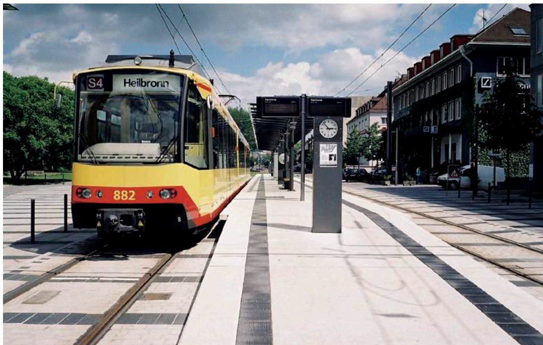
Рисунок 12 Двухсистемный легкорельсовый электропоезд с регулярным движением в рамках Транспортного объединения Карлсруэ ( Karlsruher Verkehrsverbund, KVV ).
